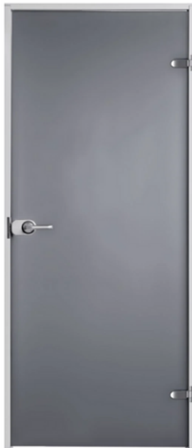
Suihku-/WC-tilan ovi, 9x21, Bath harmaa kylpyhuoneen lasiovi, 8 mm karkaistua läpikuultava lasi, musta mäntykarmi, alumiininen painike, jossa WC-vääntönuppi, tai vastaava
